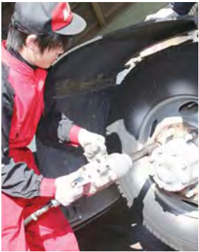
▲タイヤの脱着 大型用インパクトレンチを使ってホイールナットを外した後、2人でタイヤを外します。
