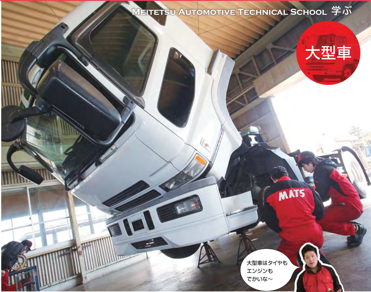
▲タイヤの脱着 大型用インパクトレンチを使ってホイールナットを外した後、2人でタイヤを外します。
